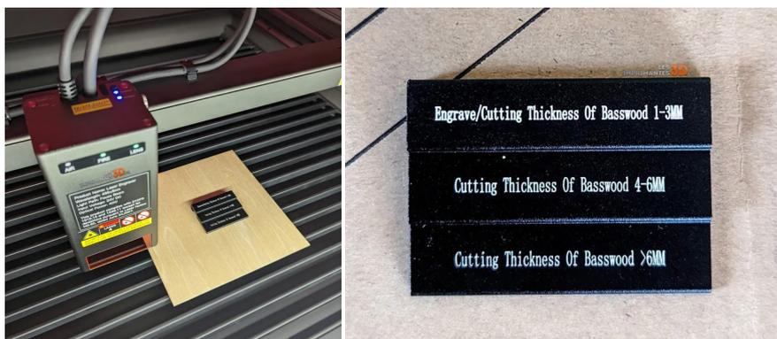
A noter que si vous l'avez perdue, un [modèle 3D sur Creality Cloud](#) permet de réimprimer cette cale de réglage du focus des graveurs CrealityFalcon.
